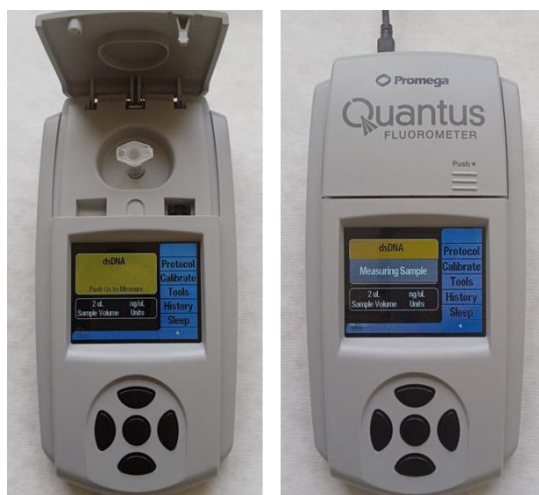
Obrázok 21 Proces merania koncentrácie dsDNA pomocou fluorometra (Quantus™, Promega).
