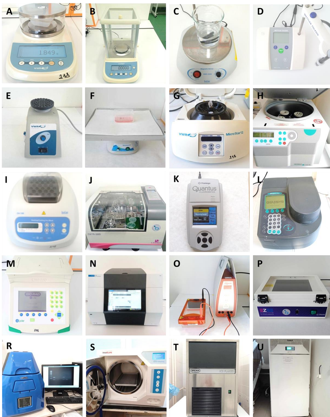
Obrázok 4 Prístrojové vybavenie laboratória pre realizáciu molekulárno-biologických analýz. A – presné váhy, B – analytické váhy, C – magnetické miešadlo, D – pH meter, E – vortex, F – trepačka, G – stolová centrifúga, H – centrifúga (s možnosťou chladenia), I – suchý kúpeľ (termoblok), J – inkubátor (mikrobiologický), K – fluorometer, L – spektrofotometer, M – PCR termocyklér, N – Real-Time PCR prístroj, O – elektroforetická aparátúra so zdrojom elektrického napätia, P – UV-transiluminátor, R – fotodokumentačné zariadenie, S – autokláv, T – výrobnik ľadovej drte, U – hlbokomraziaci box (-80 °C).
