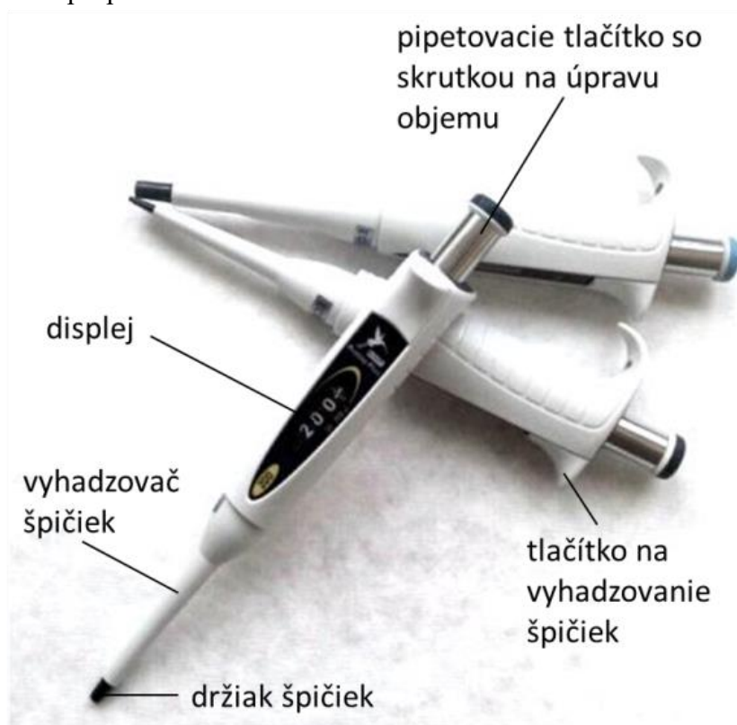
Obrázok 10 Automatická jednokanálová mikropipeta s popisom jednotlivých častí.
