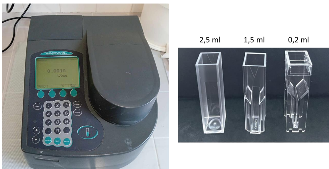
Obrázok 20 Spektrofotometer (Genesys 10UV) na meranie absorbancie nukleových kyselín v kyvete (vľavo), typy kyvety s rôznymi objemami (vpravo).
