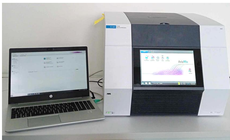
Obrázok 27 Real-Time PCR prístroj s prislúchajúcim počítačom so softvérom (vľavo) a získané amplifikačné krivky.
