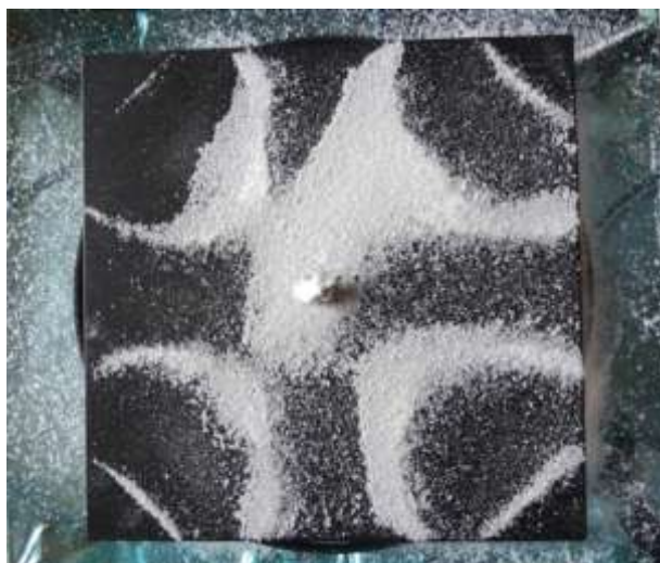
Obr. 12. Chladniho obrazce vytvorené na platni vibračného generátora.
