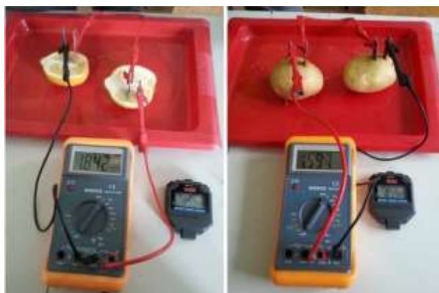
Obr. 7. Aparatúra na meranie napätia s využitím elektrochemického článku.
