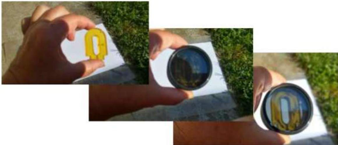
Obr. 22 Použitie kruhových polarizátorov na zistenie chybových miest v materiáli.
