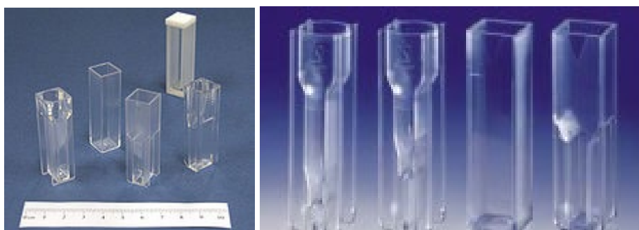
Obrázok 17. Ukážka rôznych typov kyviet pre spektrofotometriu.
