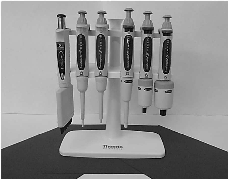
Obrázok 10: Automatické multikanálové a jednokanálové pipety.
